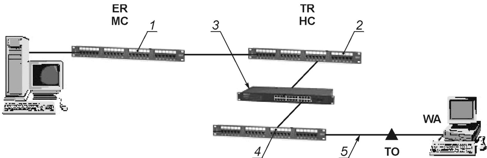
1 — аппаратный шнур с TELCO-коннекторами в MC; 2 — коммутационный модульный шнур в HC; 3 — коммутационный шнур к активному оборудованию в HC; 4 — коммутационный модульный шнур в HC; 5 — горизонтальная кабельная подсистема
