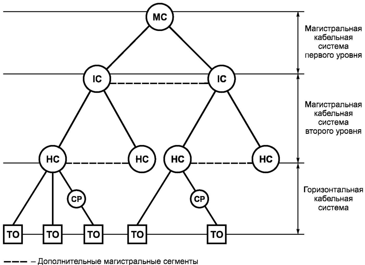
Рисунок 5 — Централизованная структура кабельной системы
