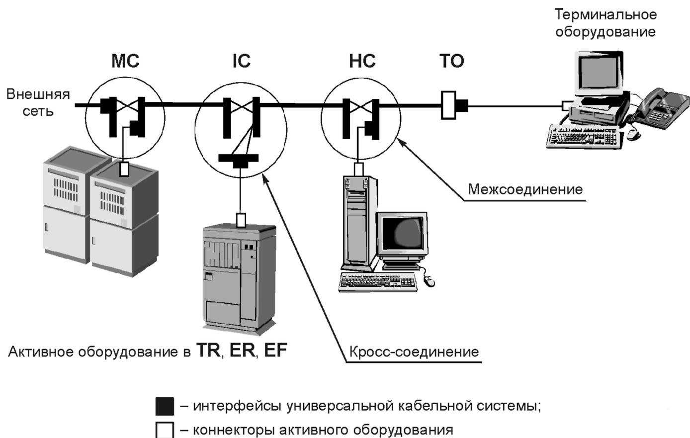
Рисунок 7 — Интерфейсы кабельной системы
