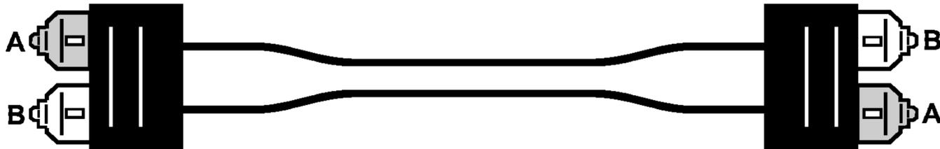
Рисунок 11 — Волоконно-оптический коммутационный шнур типа 568SC
