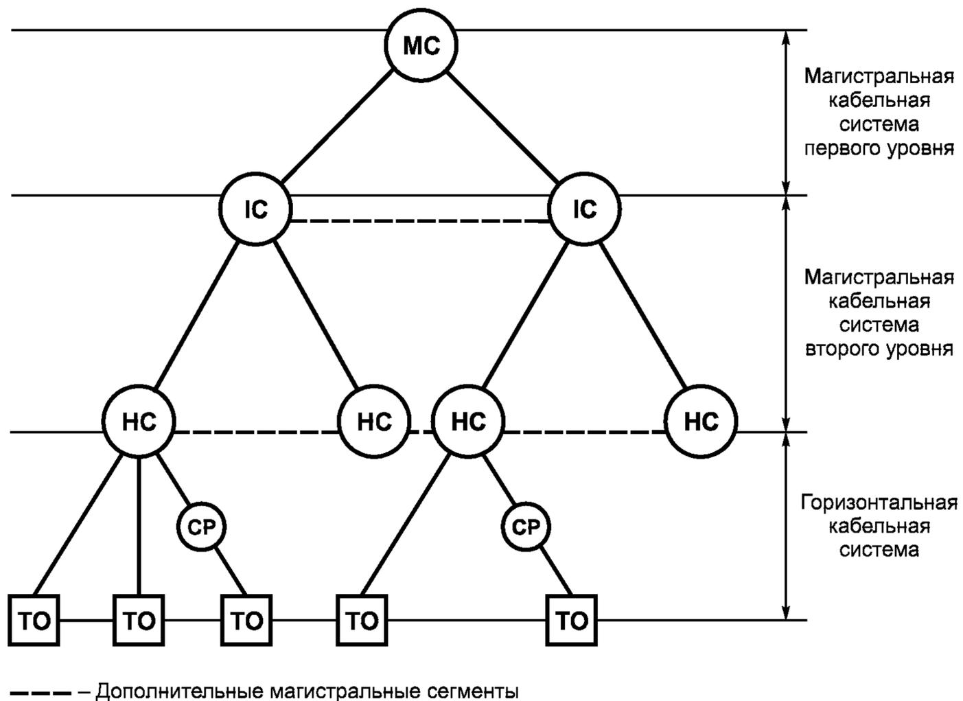
Рисунок 4 — Иерархическая структура кабельной системы
