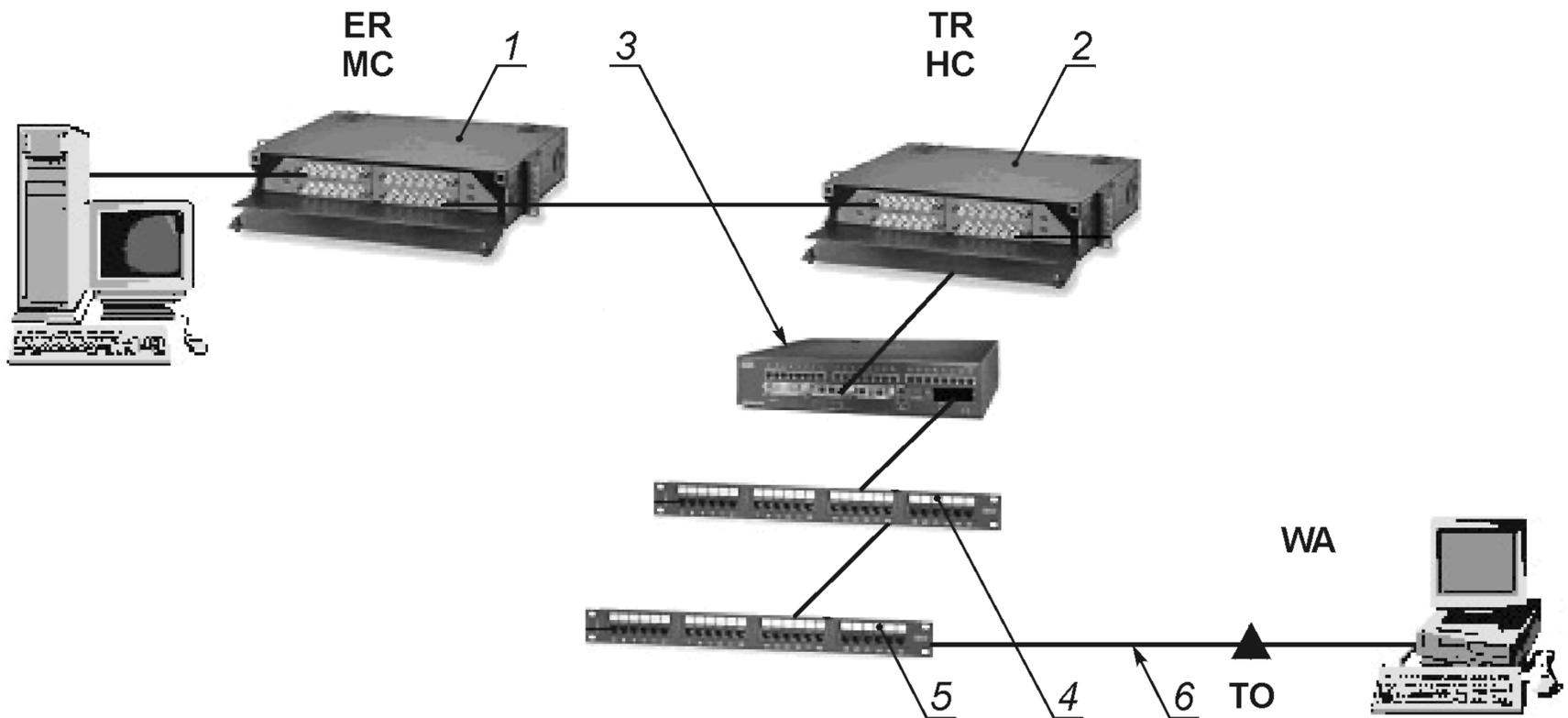
1 — аппаратный волоконно-оптический шнур в MC; 2 — магистральная волоконно-оптическая кабельная подсистема; 3 — аппаратный волоконно-оптический шнур в HC; 4 — аппаратный шнур с TELCO-коннекторами в HC; 5 — коммутационный модульный шнур в HC; 6 — горизонтальная кабельная подсистема
