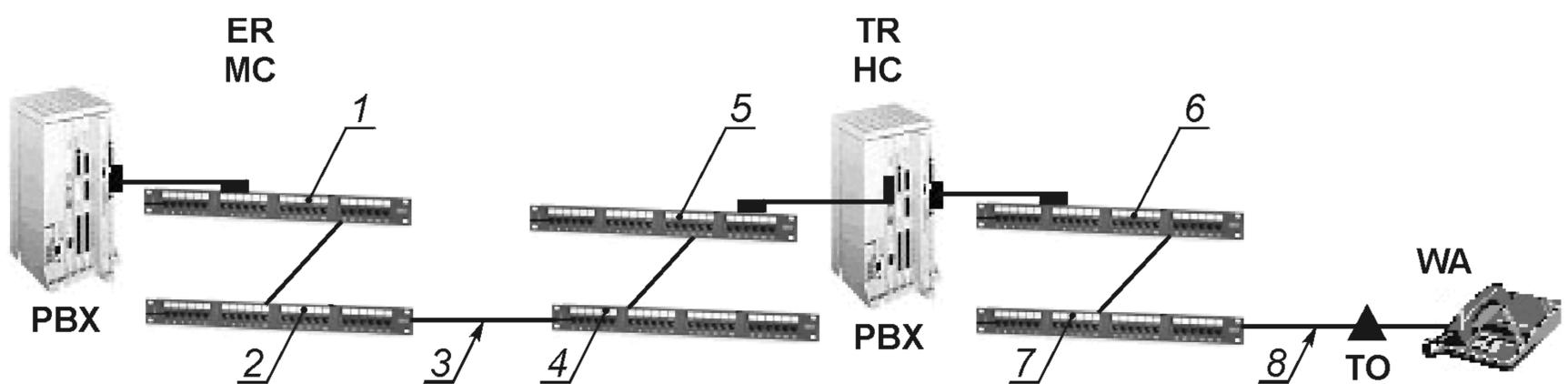
1 — аппаратный шнур с TELCO-коннекторами в MC; 2 — коммутационный модульный шнур в MC; 3 — магистральная кабельная подсистема; 4 — коммутационный модульный шнур в HC; 5 — аппаратный шнур с TELCO-коннекторами в HC; 6 — аппаратный шнур с TELCO-коннекторами в HC; 7 — коммутационный модульный шнур в HC; 8 — горизонтальная кабельная подсистема
