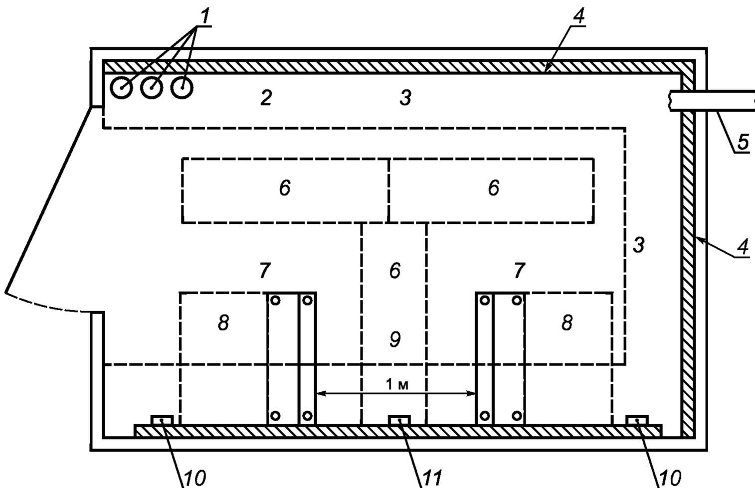
1 — три рукава диаметром 100 мм каждый (минимальное условие); 2 — распределительная система; 3 — лестничный кабельный лоток; 4 — монтажная плита, ДСП 20 мм; 5 — система связи телекоммуникационных, конduit, калибр как минимум 3 (78 мм); 6 — потолочный светильник; 7 — аппаратная стойка; 8 — пространство доступа к питанию и системе заземления; 9 — технологическое пространство доступа; 10 — питание оборудования; 11 — вспомогательное питание
